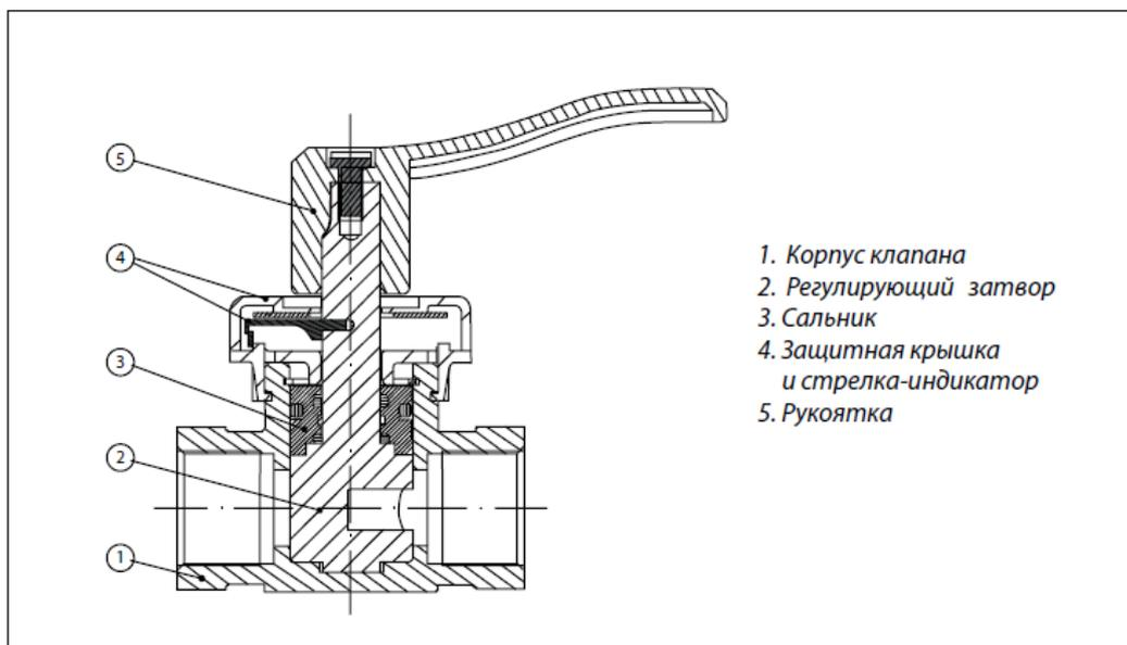
1. Корпус клапана
