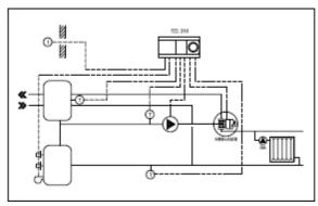
Система отопления с котлом, управляемая контроллером ECL и клапаном регулирующим типа HRB.
