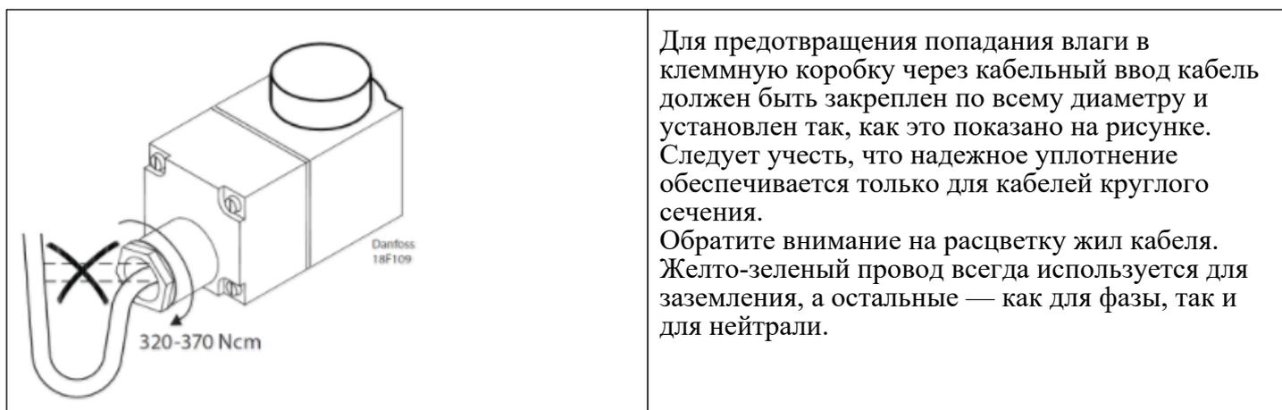
Для предотвращения попадания влаги в клеммную коробку через кабельный ввод кабель должен быть закреплен по всему диаметру и установлен так, как это показано на рисунке. Следует учесть, что надежное уплотнение обеспечивается только для кабелей круглого сечения.
