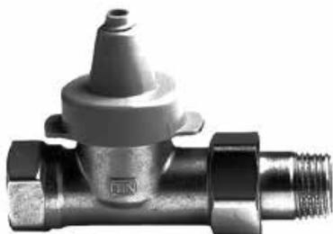
Клапан регулирующий типа RAV предназначен для применения с термоэлектрическими приводами ABV и TWA-V в системах отопления и охлаждения зданий. Клапан регулирующий типа RAV модификации 8 может также совмещаться с термоэлементами прямого действия RAVV, RAVK или RAVI.
