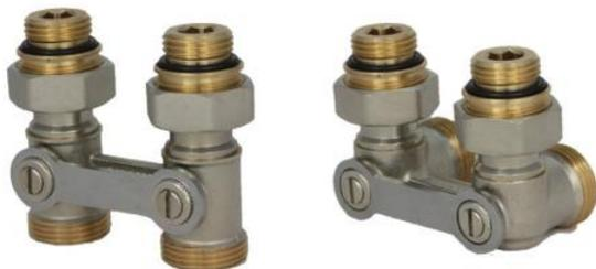
Клапаны запорные типа RLV-KB предназначены для применения в двухтрубных насосных системах водяного отопления с целью отключения отдельного отопительного прибора для его демонтажа или технического обслуживания без опорожнения всей системы. Не предназначены для контакта с питьевой водой в системах хозяйственно-питьевого водоснабжения.
