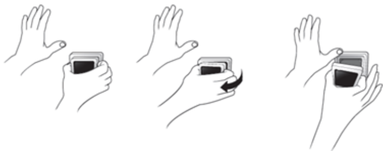
Рис. 8. Демонтаж модуля дисплея.
