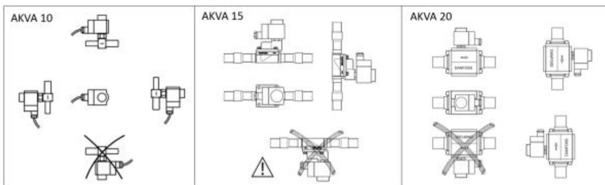
Обратите внимание, что не допускается установка клапана катушкой вниз (под любым углом). Корпус клапана выдерживает очень высокое внутреннее давление, однако следует не допускать возможности возникновения сильного роста давления, вызванного термическим расширением хладагента в замкнутых объемах. Также необходимо убедиться, что клапан защищен от "гидроудара" в
