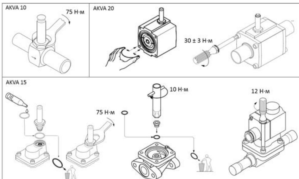
Не рекомендуется превышать максимальные значения усилия затяжки, приведенные в таблице! Для замены используйте только подлинные детали производства компании «Дanfoss», включая уплотнительные кольца и прокладки. Материалы новых деталей сертифицированы для соответствующего хладагента.
