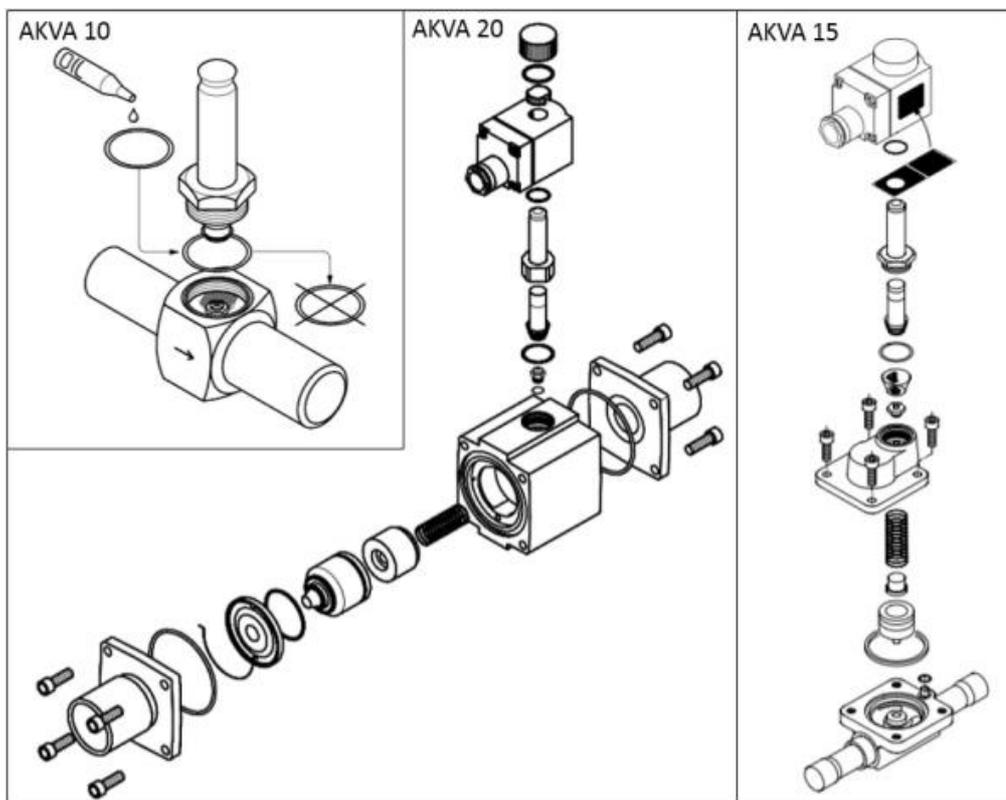
Не допускается разборка и демонтаж клапана при наличии давления в системе.
