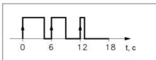
Потребность в охлаждении определяется контроллером. Когда охлаждение не требуется, клапан остается закрытым.
