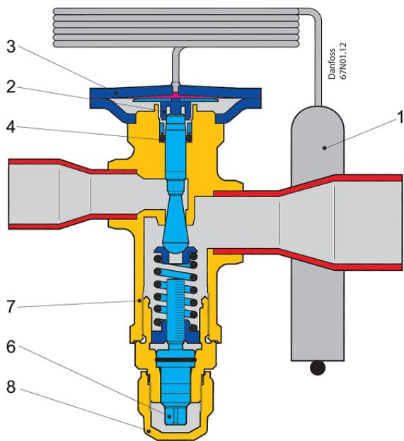
1. Термобаллон с капиллярной трубкой (нержавеющая сталь)
