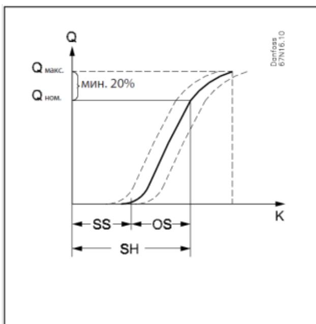
SS - статический перегрев (перегрев начала открытия клапана),
