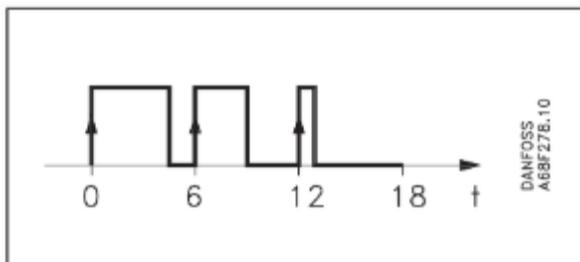
Если необходимо интенсивное охлаждение, клапан останется открытым в течение всех 6 секунд. Если требуется умеренное охлаждение, клапан останется открытым только в течение части цикла регулирования. Необходимая интенсивность охлаждения определяется контроллером.
