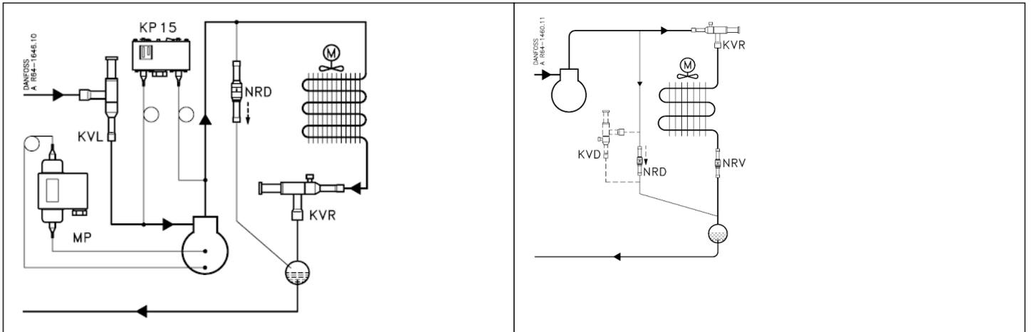
В том случае, если в ресивере необходимо поддерживать определенное давление, не зависящее от текущего давления на линии нагнетания, вместо клапана-регулятора перепада давления типа NRD в комплекте с клапаном типа KVR рекомендуется использовать клапан-регулятор давления типа KVD.
