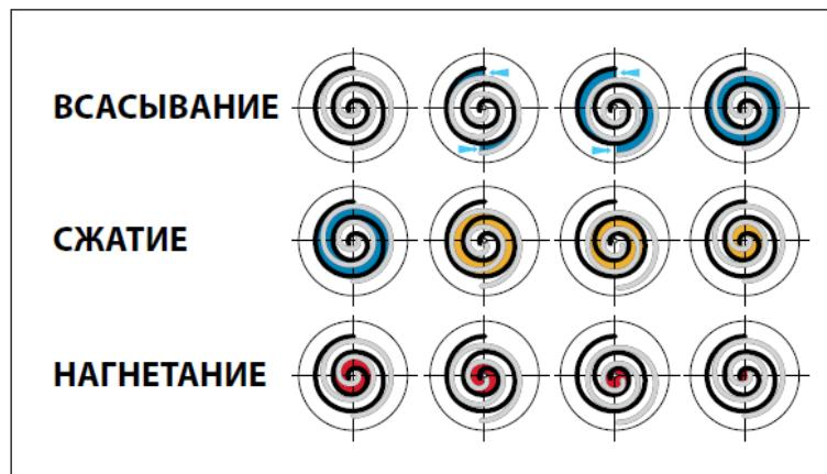
В компрессоре сжатие газа производится двумя элементами, имеющими форму спиралей, которые расположены в верхней части компрессора над электродвигателем (см. рисунок вверху). Всасываемый газ поступает в компрессор через всасывающий патрубок, обтекает электродвигатель, обеспечивая полное охлаждение компрессора во всех режимах работы. Капли масла, находящиеся в газе, выделяются из него и падают в картер компрессора. Пройдя через электродвигатель, газ попадает в спиральные элементы компрессора.
