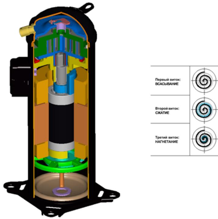
В компрессоре сжатие газа производится двумя элементами, имеющими форму спиралей, которые расположены в верхней части компрессора над электродвигателем (см. рисунок вверху). Всасываемый газ поступает в компрессор через всасывающий патрубок, обтекает электродвигатель, обеспечивая полное охлаждение компрессора во всех режимах работы. Капли масла, находящиеся в газе, выделяются из него и падают в картер компрессора. Пройдя через электродвигатель, газ попадает в спиральные элементы компрессора.
