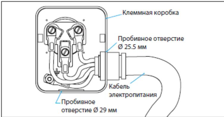
Степень защиты клеммных коробок компрессоров всех моделей составляет IP54 в соответствии со стандартом IEC529. Степень защиты действительна только в случае использования кабельных вводов правильного размера.
