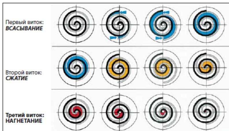
В компрессоре сжатие газа производится двумя элементами, имеющими форму спиралей, которые расположены в верхней части компрессора над электродвигателем (см. рисунок вверху). Всасываемый газ поступает в компрессор через всасывающий патрубок, обтекает кожух электродвигателя и входит в него через отверстия в нижней части кожуха. Капли масла, находящиеся в газе, выделяются из него и
