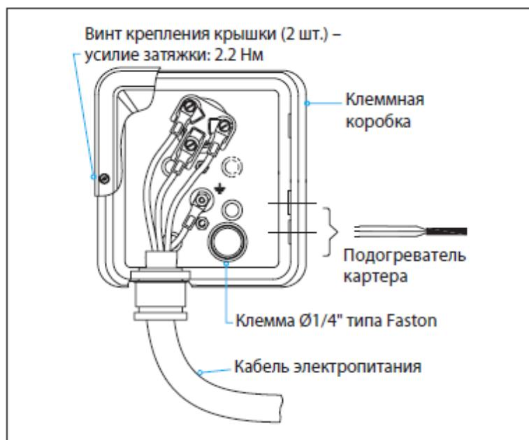
Степень защиты клеммных коробок компрессоров всех моделей составляет IP54 в соответствии со стандартом IEC529. Степень защиты действительна только в случае использования кабельных вводов
