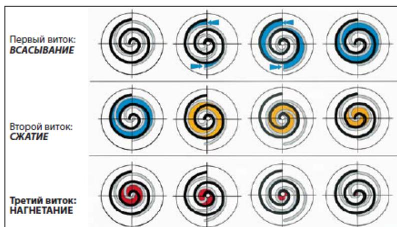
В компрессоре сжатие газа производится двумя элементами, имеющими форму спиралей, которые расположены в верхней части компрессора над электродвигателем (см. рисунок вверху). Всасываемый газ поступает в компрессор через всасывающий патрубок, обтекает кожух электродвигателя и входит в него через отверстия в нижней части кожуха. Капли масла, находящиеся в газе, выделяются из него и падают в картер компрессора. Газ проходит через электродвигатель, обеспечивая полное охлаждение
