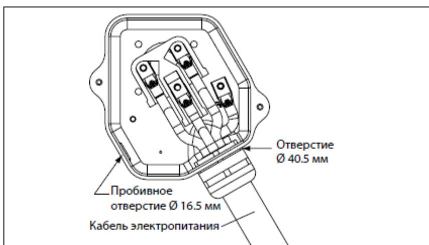
Степень защиты клеммных коробок компрессоров всех моделей составляет IP54 в соответствии со стандартом IEC529. Степень защиты действительна только в случае использования кабельных вводов правильного размера.
