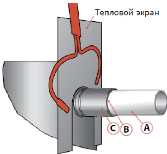
Переместите горелку на участок С, чтобы припой смог затечь в зазоры стыка. Подавайте тепло к участку С на короткое время, чтобы припой не попал в компрессор.
