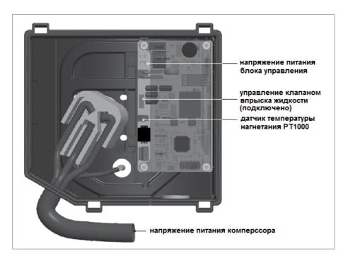
Блок управления должен подключаться к напряжению питания 230 В и иметь заземление, подключаемое к разъему 1/4" типа faston
