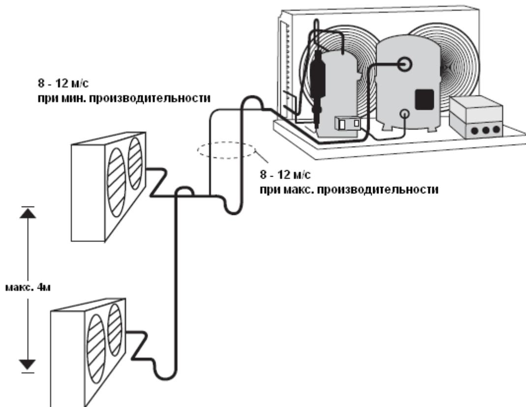
Время пребывания агрегата компрессорно-конденсаторного под воздействием атмосферы должно быть сведено к минимуму. Подсоединение агрегата к системе должно производиться достаточно быстро, чтобы исключить попадание влаги в масло, находящееся в компрессоре.
