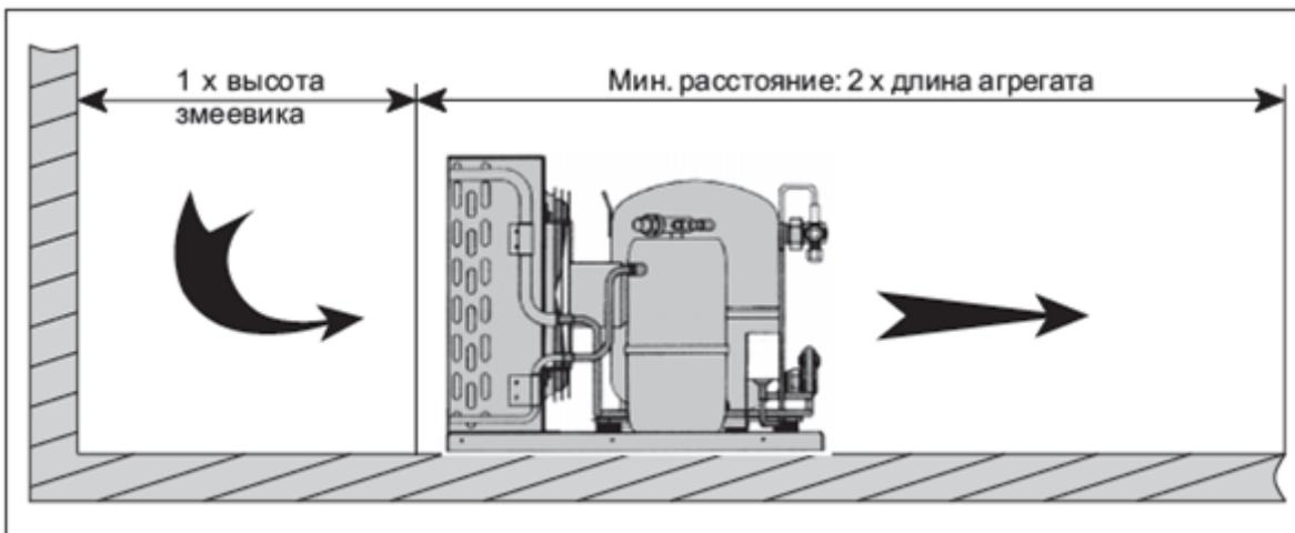
Агрегат компрессорно-конденсаторный должен быть установлен на ровную горизонтальную поверхность с углом наклона не более  $3^\circ$ .
