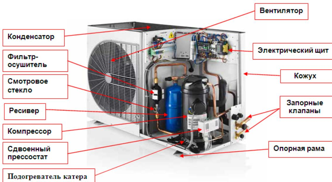
Агрегат компрессорно-конденсаторный является частью холодильной установки.
