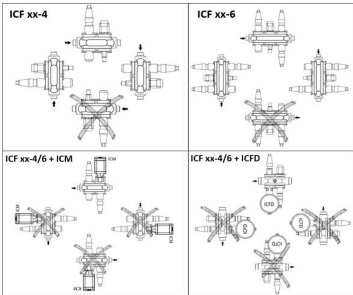
Направление потока рабочей среды должно совпадать с направлением стрелки на корпусе клапана. Обратите внимание, что установка клапанов ICF с функциональным модулем ICM или ICFD, допустима только горизонтально.
