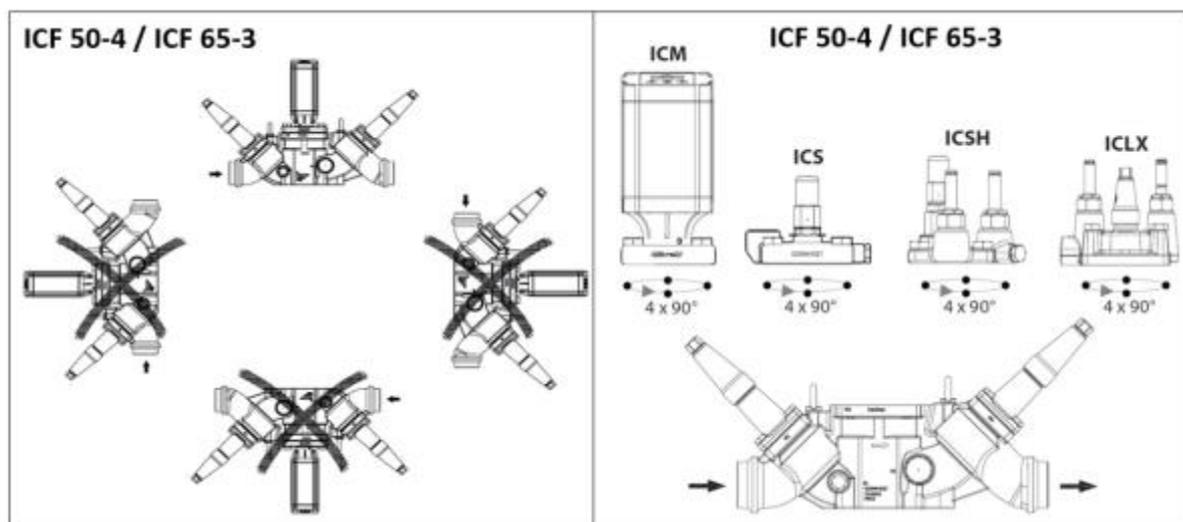
Направление потока рабочей среды должно совпадать с направлением стрелки на корпусе клапана. Поворот модуля на 90° относительно поверхности корпуса не влияет на работу клапана. Корпус клапана выдерживает очень высокое внутреннее давление, однако следует не допускать возможности возникновения сильного роста давления, вызванного термическим расширением хладагента в замкнутых объемах. Также необходимо убедиться, что клапан защищен от "гидроудара" в системе.
