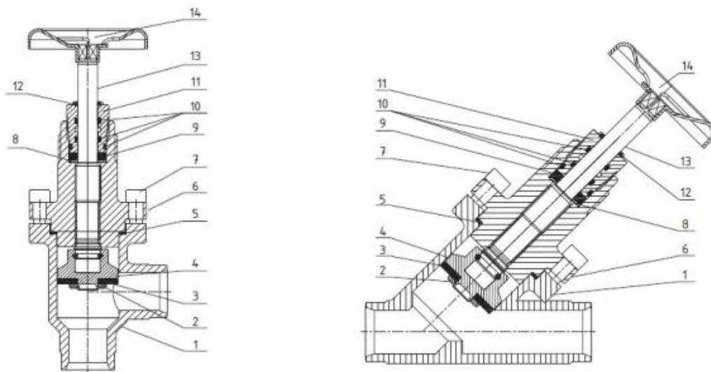
Рис. 1 – Конструкция клапана SVA
