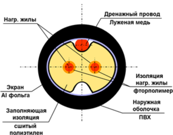
Рис. 2. Устройство нагревательного кабеля ДЕВИ Snow-30Т
