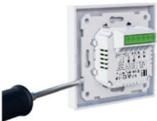
**ШАГ 2:** Присоедините провода к клеммам терморегулятора согласно схеме соединений (изображена на обратной стороне корпуса прибора; схема представлена также в разделе "Описание и работа"):
