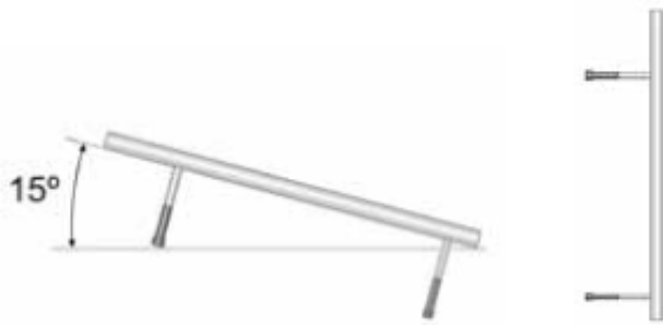
Монтаж теплообменников микроканальных типа MCHE
