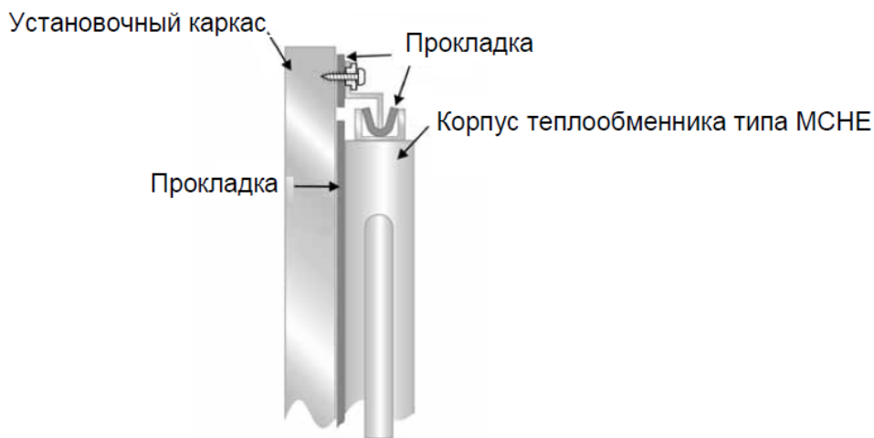
Монтаж теплообменников микроканальных типа МСНЕ.
