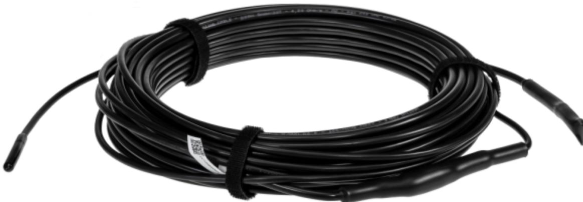
Соединение питающего и нагревательного кабелей выполнено через герметичную термоусадочную муфту. На противоположном конце нагревательного кабеля его две жилы закорочены и помещены в герметичную концевую муфту. Степень защиты нагревательной секции от проникновения влаги соответствует IPX7.
