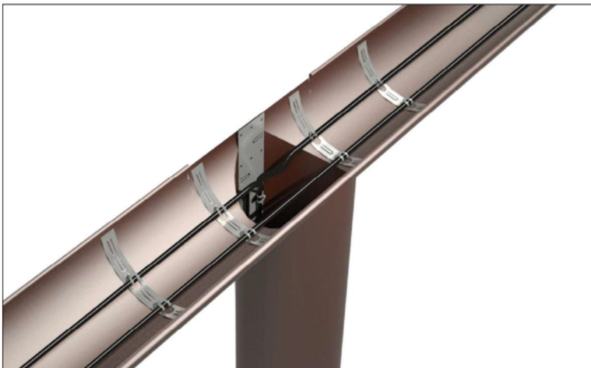
Крепление кабеля в жёлобе выполнено на отрезках одинарной монтажной ленты, закреплённых в жёлобе в направлении перпендикулярном линиям кабеля. В водосточной трубе кабель провешен в две линии на двойной монтажной ленте с шагом укладки 5 см, что обеспечивает линейную мощность в трубе 60 Вт/м.
