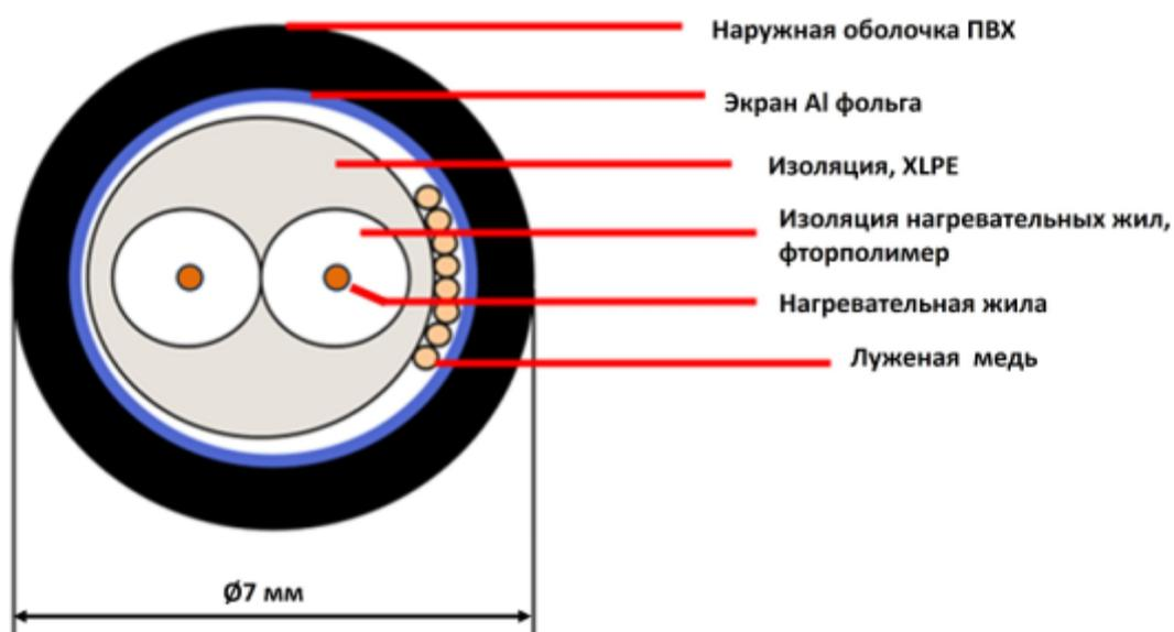
Нагревательная секция представляет собой гибкий греющий элемент. Принцип его действия – выделение джоулева тепла нагревательными жилами при протекании по ним электрического тока. Сопротивление нагревательных жил подбирается таким образом, чтобы обеспечить для каждой нагревательной секции линейную (погонную) мощность 30 Вт/м при напряжении переменного тока 230 В.
