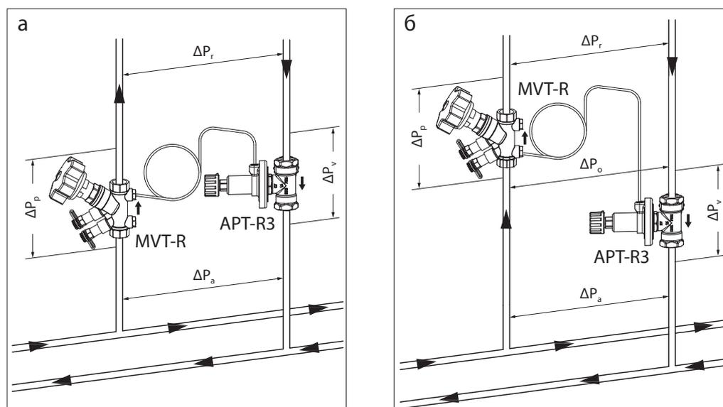
Рис. 1. Схемы подключения импульсной трубки к клапану-партнеру. а — настройка на АРТ-R3 принимается равной  $\Delta P_r$  — сопротивлению стояка. Клапан партнер находится вне зоны регулирования; б — настройка на АРТ-R3 принимается равной  $\Delta P_o$  — сопротивлению стояка и клапана партнера. Клапан партнер находится в зоне регулирования
