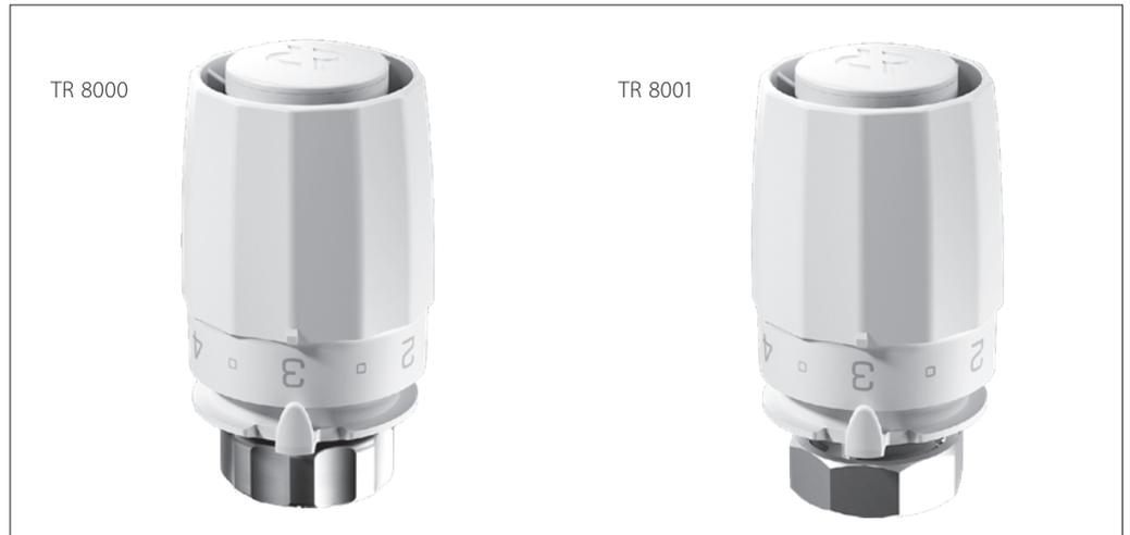
Термостатические элементы серии TR 8000 — устройства автоматического регулирования температуры, предназначенные для комплектации радиаторных терморегуляторов Ридан TR-N и TR-G, а так же Danfoss RA-N/G и RTR-N/G. Имеют присоединение M30x1,5 для термозлемента TR 8001 и присоединение RTR/RA для TR 8000, совместимые с клапанами Danfoss.
