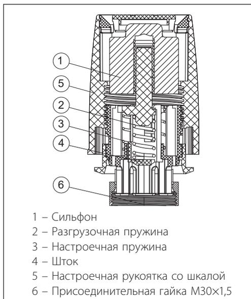
Основное устройство термостатического элемента — сильфон, который обеспечивает пропорциональное регулирование. Датчик термоэлемента воспринимает изменение температуры окружающего воздуха. Сильфон и датчик заполнены специальной термочувствительной жидкостью.
