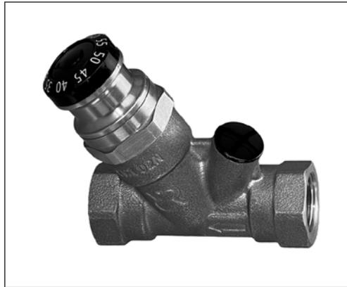
Термостатический балансировочный клапан АНТ-R — регулятор температуры прямого действия, предназначен для стабилизации температуры и минимизации расхода воды в циркуляционных стояках систем горячего водоснабжения (ГВС).
