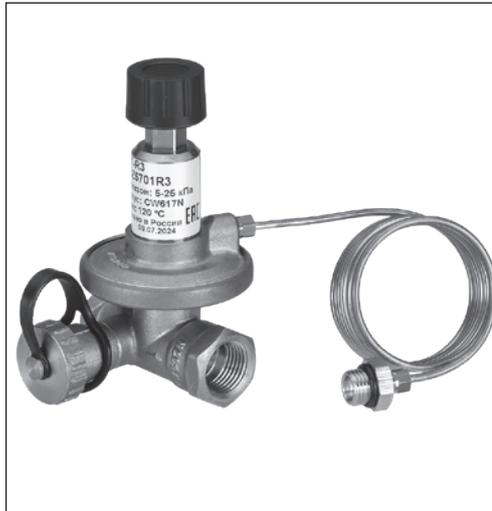
Балансировочные клапаны АРТ-R3 используются для гидравлической балансировки систем отопления и охлаждения с переменным расходом. При частичных нагрузках, когда регулирующие клапаны снижают расход, перепад давления поддерживается постоянным, и, таким образом, обеспечивается нужный расход в любой момент времени. Такая балансировка системы обеспечивает энергосбережение, повышает комфорт и управляемость климатической системы.
