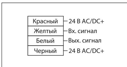
**Электрическая схема подключения AME 110NLXR, трехточечное управление**
