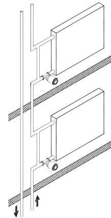
б — вертикальная система с нижней подачей теплоносителя
