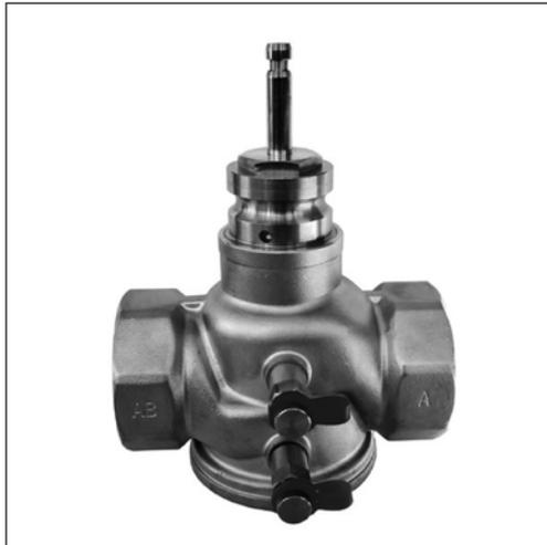
Комбинированные автоматические балансировочные клапаны AQT-R DN40–50 сочетают в себе функции ограничителя расхода и регулирующего клапана. При применении AQT-R DN40–50 без привода клапан в автоматическом режиме обеспечивает настроенный расход (требуется фиксатор штока). Совместно с приводом клапан позволяет регулировать расход тепло- или холодоносителя, при этом авторитет клапана стремится к единице.
