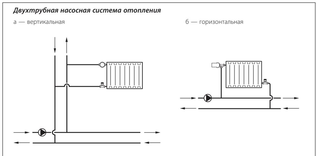
Для предотвращения отложений и коррозии клапаны терморегуляторов TR-N следует применять в системах водяного отопления, где теплоноситель отвечает требованиям Правил технической эксплуатации электрических станций
