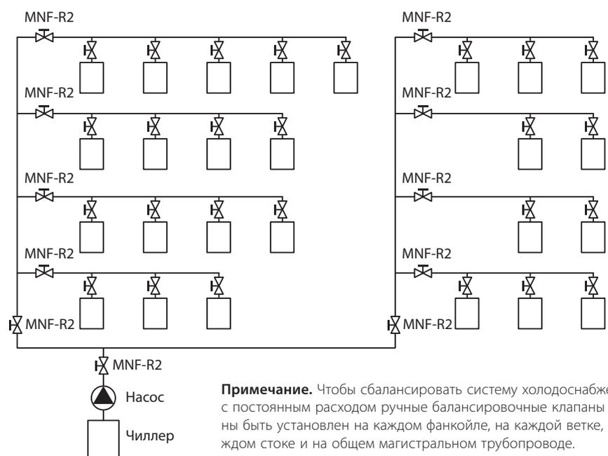
**Примечание.** Чтобы сбалансировать систему холодоснабжения с постоянным расходом ручные балансировочные клапаны должны быть установлены на каждом фанкойле, на каждой ветке, на каждом стоке и на общем магистральном трубопроводе.
