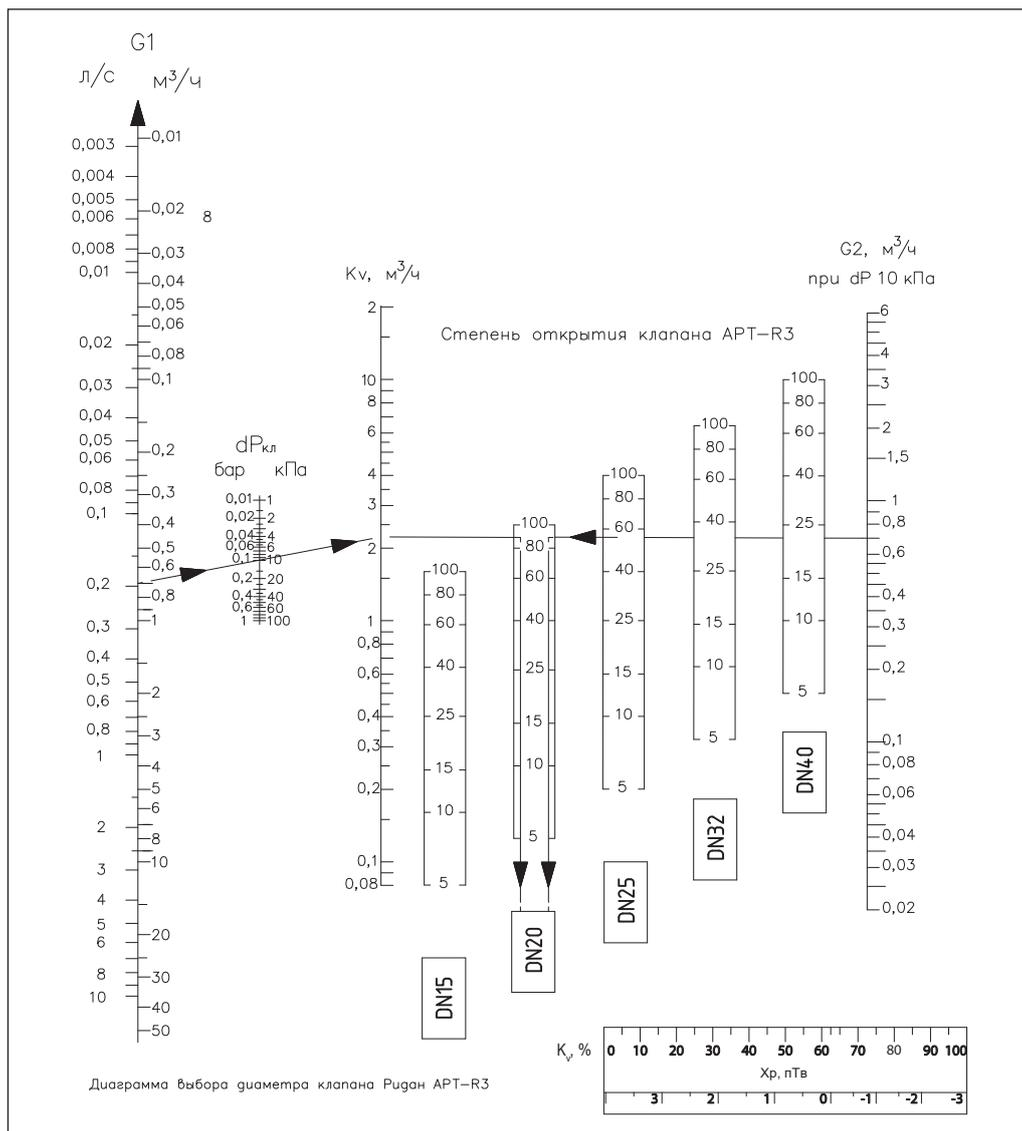
Диаграмма позволяет подобрать клапаны АРТ-R3 при различном перепаде давления. Для подбора клапана проведите прямую линию от левой шкалы расхода  $G_1$  до шкалы пропускной способности  $K_v$ , через значение потерь давления на клапане  $dP_{кл}$ . Далее проведите горизонтальную линию до пересечения с колонками, показывающими степень открытия клапанов различных диаметров. Выбираем клапан с наибольшей степенью открытия.
