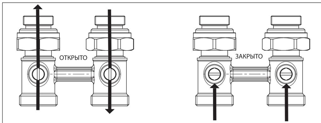
Для настройки полного открытия или закрытия клапана используйте плоскую отвертку, соответствующую размеру паза.
