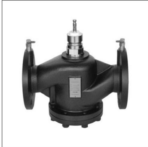
Комбинированный автоматический балансировочный клапан AQF-R сочетает в себе функции ограничителя расхода и регулирующего клапана. При применении AQF-R без привода клапан в автоматическом режиме обеспечивает настроенный расход (требуется фиксатор штока). Совместно с приводом также позволяет регулировать расход тепло- или холодоносителя, при этом авторитет клапана стремится к единице.
