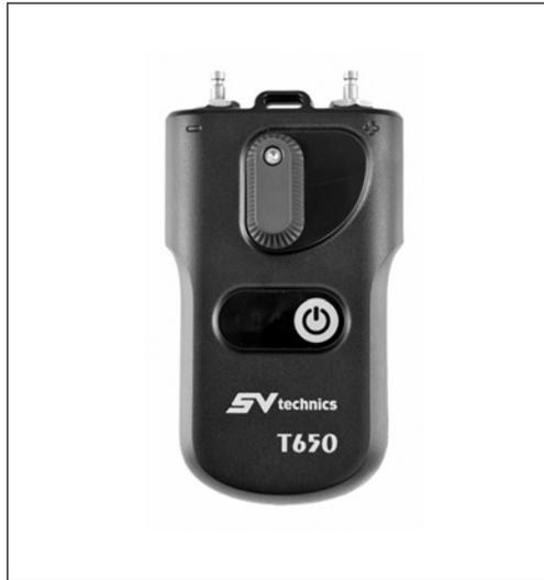
Измерительный прибор T650 предназначен для определения расхода, проходящего через компоненты (балансировочные клапаны или измерительные диафрагмы) гидравлической системы. Прибор рассчитывает расход, исходя из измеренного перепада давления и вносит необходимые поправочные коэффициенты в случае, если в качестве среды используются водогликолевые смеси.
