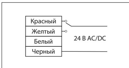
**Электрическая схема подключения AME 110MR**
