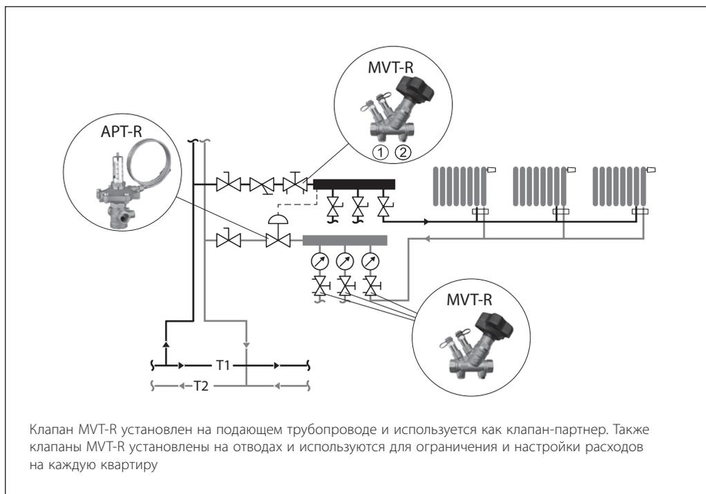
**Применение в вертикальной однотрубной системе отопления**
