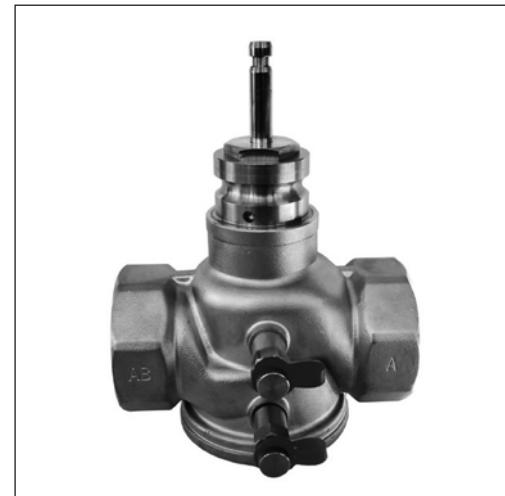
Комбинированные автоматические балансировочные клапаны AQT-R DN40–50 сочетают в себе функции ограничителя расхода и регулирующего клапана. При применении AQT-R DN40–50 без привода клапан в автоматическом режиме обеспечивает настроенный расход (требуется фиксатор штока). Совместно с приводом клапан позволяет регулировать расход тепло- или холдоносителя, при этом авторитет клапана стремится к единице.
