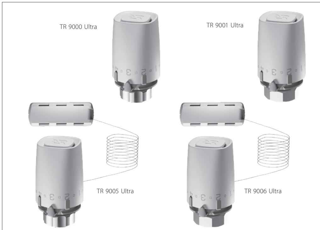
Терmostатические элементы серии TR 9000 Ultra — устройства автоматического регулирования температуры, предназначенные для комплектации радиаторных терморегуляторов Ридан TR-N и TR-G а так же Danfoss RA-N/G и RTR-N/G. Имеют присоединение M30x1,5 для термоэлемента TR 9001 Ultra и TR 9006 Ultra и присоединение RTR/RA для TR 9000 Ultra и TR 9005 Ultra, совместимые с клапанами Danfoss.
