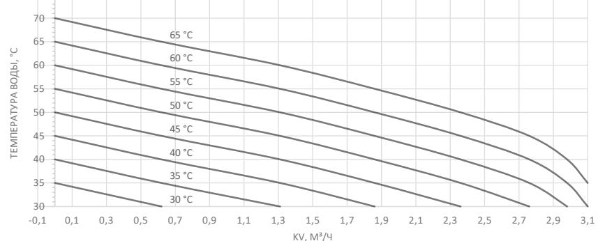
Зависимость Kv клапана АНТ-Р DN25 от его настройки и температуры воды
