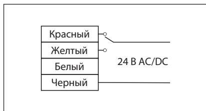
**Электрическая схема подключения AME 110MR**
