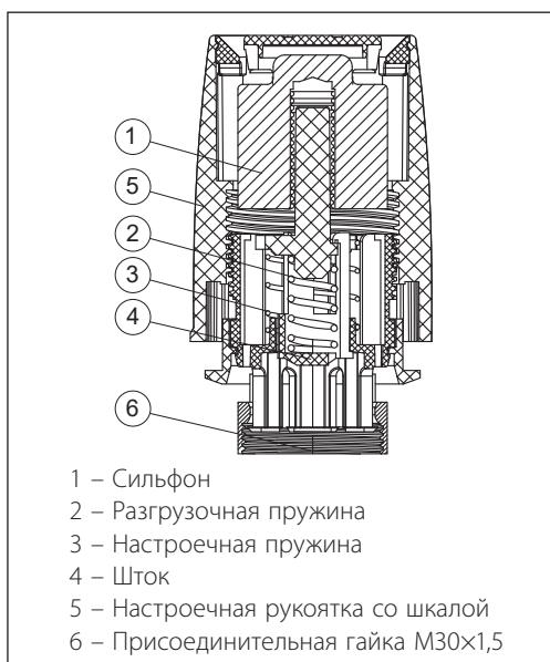
Основное устройство терmostатического элемента — сильфон, который обеспечивает пропорциональное регулирование. Датчик термоэлемента воспринимает изменение температуры окружающего воздуха. Сильфон и датчик заполнены специальной термочувствительной жидкостью.
