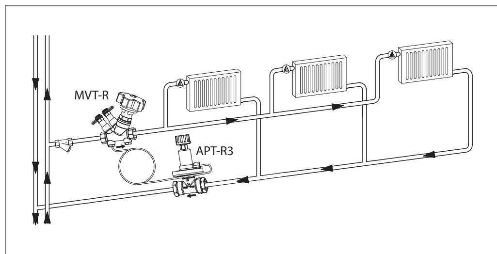
Рис. 3. Клапаны APT-R3 + MVT-R на горизонтальной ветке системы отопления
