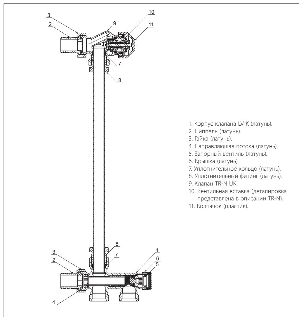
**Предварительная настройка клапана TR-K**
