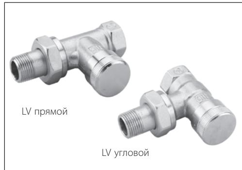
Клапаны запорные LV применяются в двухтрубных насосных системах водяного отопления для отключения отдельного отопительного прибора для его демонтажа или технического обслуживания без опорожнения всей системы.
