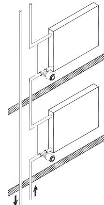
б — вертикальная система с нижней подачей теплоносителя
