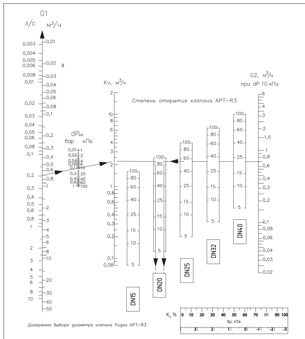
Диаграмма позволяет подобрать клапаны APT-R3 при различном перепаде давления. Для подбора клапана проведите прямую линию от левой шкалы расхода G1 до шкалы пропускной способности Kv, через значение потерь давления на клапане  $dP_{кл}$ . Далее проведите горизонтальную линию до пересечения с колонками, показывающими степень открытия клапанов различных диаметров. Выбираем клапан с наибольшей степенью открытия.
