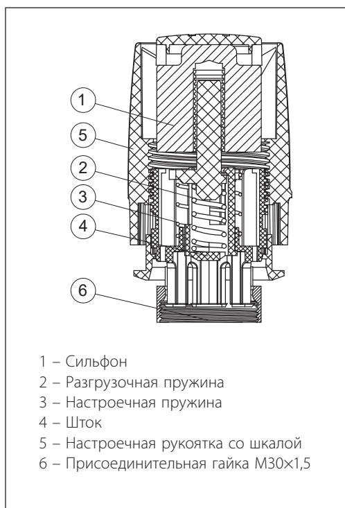
Основное устройство терmostатического элемента — сильфон, который обеспечивает пропорциональное регулирование. Датчик термоэлемента воспринимает изменение температуры окружающего воздуха. Сильфон и датчик заполнены специальной термочувствительной жидкостью.
