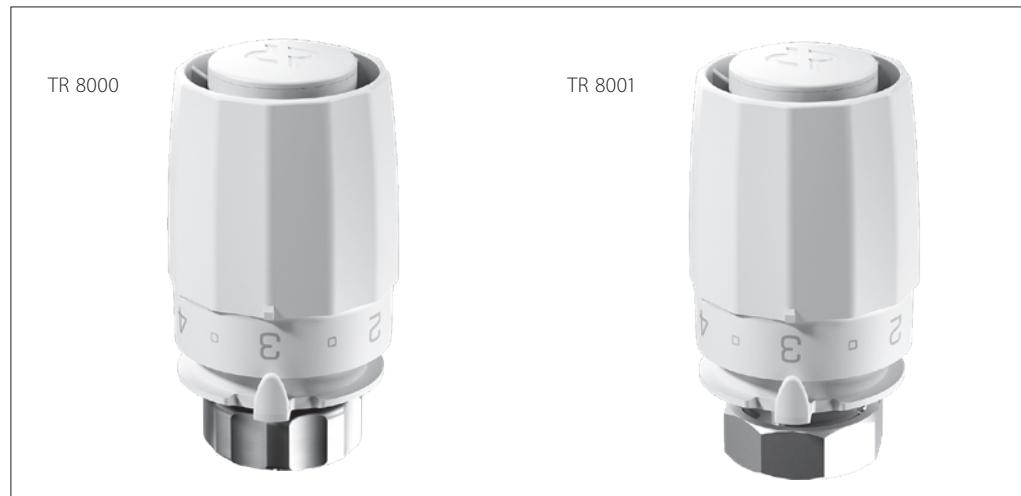
Терmostатические элементы серии TR 8000 — устройства автоматического регулирования температуры, предназначенные для комплектации радиаторных терморегуляторов Ридан TR-N и TR-G, а так же Danfoss RA-N/G и RTR-N/G. Имеют присоединение M30x1,5 для термоэлемента TR 8001 и присоединение RTR/RA для TR 8000, совместимые с клапанами Danfoss.
