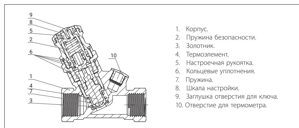
**Работа клапана АНТ-R**
