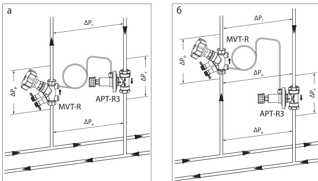
Рис. 1. Схемы подключения импульсной трубы к клапану-партнеру. а — настройка на APT-R3 принимается равной  $\Delta P_r$  — сопротивлению стояка. Клапан партнер находится вне зоны регулирования; б — настройка на APT-R3 принимается равной  $\Delta P_o$  — сопротивлению стояка и клапана партнера. Клапан партнер находится в зоне регулирования
