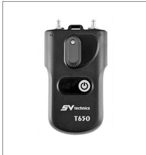
Измерительный прибор T650 предназначен для определения расхода, проходящего через компоненты (балансировочные клапаны или измерительные диафрагмы) гидравлической системы. Прибор расчитывает расход, исходя из измеренного перепада давления и вносит необходимые поправочные коэффициенты в случае, если в качестве среды используются водогликолевые смеси.
