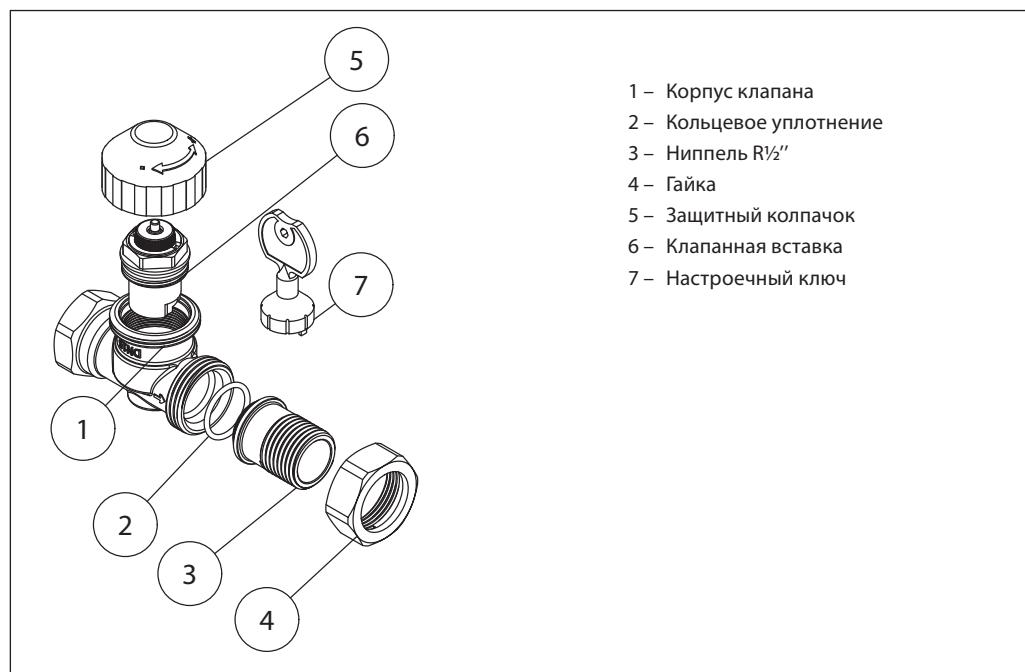
Радиаторный терморегулятор состоит из двух частей: универсального термостатического элемента серии TR и регулирующего клапана с предварительной настройкой TR-N. Термостатический элемент и регулирующий клапан заказываются отдельно.
