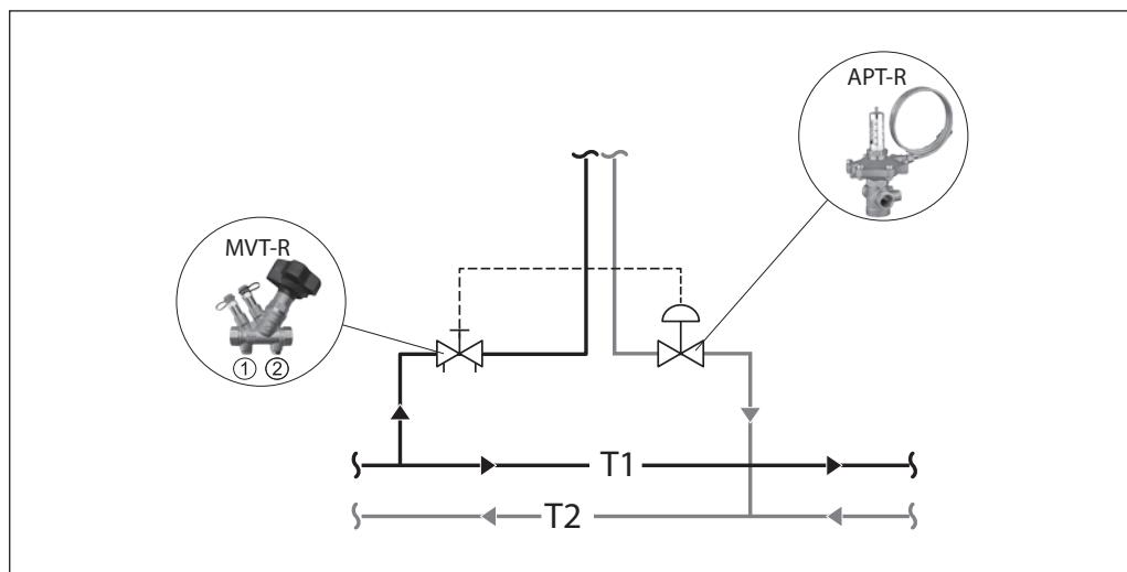
В горизонтальных системах, автоматический балансировочные клапаны APT-R может устанавливаться на обратном трубопроводе квартирного или этажного распределительного узла. При этом на подающем трубопроводе должен быть установлен клапан-партнер MVT-R, который обеспечивает функции ограничения расхода и измерения.
