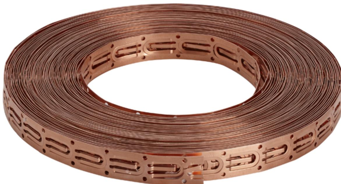
Зажимы для кабеля и крепёжные отверстия на ленте получены путём специальной перфорации. Каждый зажим ленты имеет язычок с отгибом и полукруглый лепесток. Лепесток выступает над поверхностью ленты, что облегчает его загиб, например, отвёрткой. Небольшой отгиб на конце язычка обеспечивает надёжное закрепление кабеля "в замок". Зажимы расположены в продольном направлении через 25 мм.
