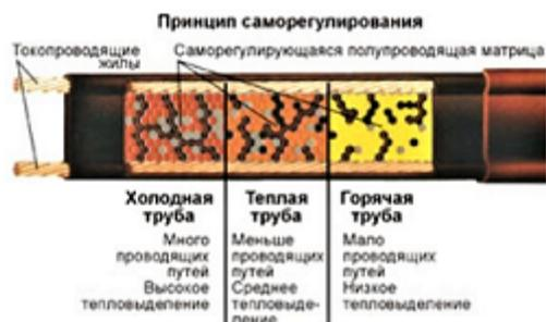
В основе производства саморегулирующейся матрицы положен метод экструзии и последовательного равномерного охлаждения. Благодаря этой технологии саморегулирующаяся матрица приобретает одинаковое сопротивление и одинаковую мощность по всей длине. В результате последующей обработки матрицы радиационным излучением происходит "сшивание" её полимерных волокон. Это
