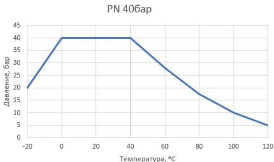
рис.3: Зависимость рабочего давления от температуры перемещаемой среды
