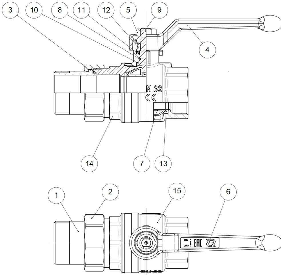
Рис. 2 Конструкция шарового крана DN32 мм
