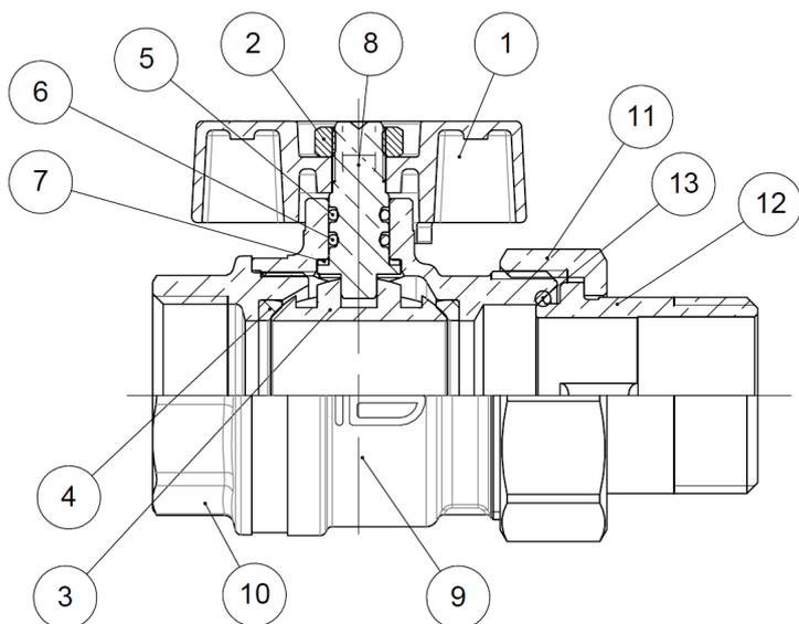
Рис. 1 Конструкция шарового крана DN 15-25 мм
