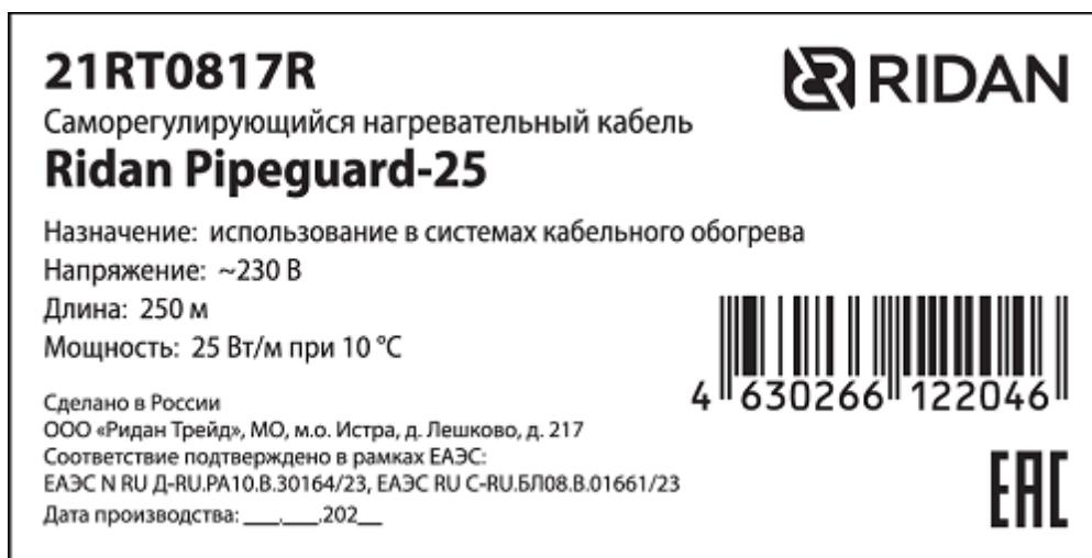
Вид этикетки (стикера) на катушке с отрезным нагревательным кабелем Ridan Pipeguard-25. Поставка кабеля от 100 м ± 1% на катушках:
