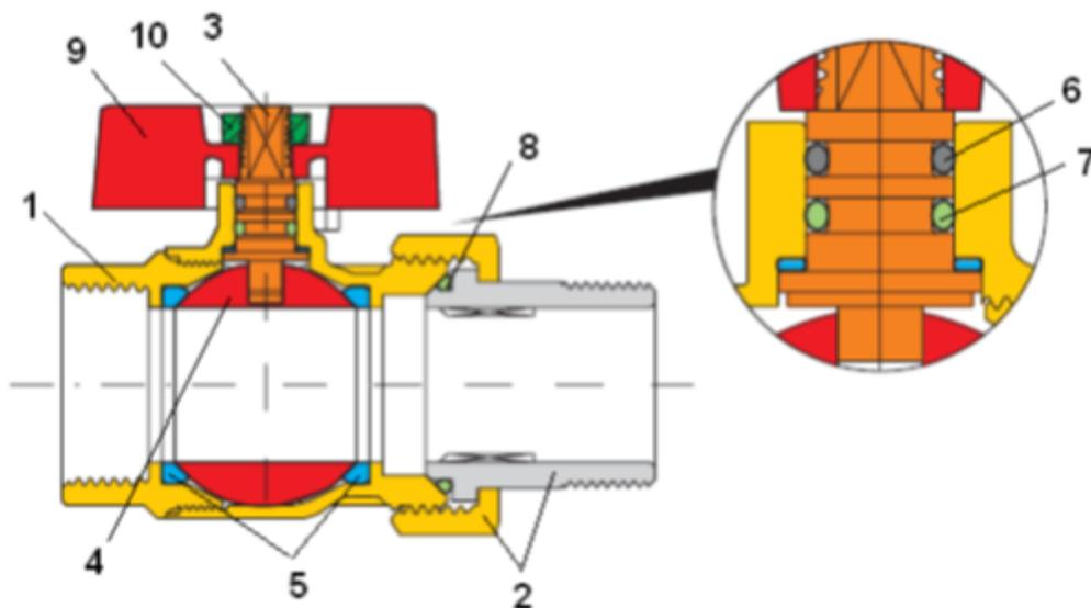
рис.2: Материалы деталей крана DN 25 мм
