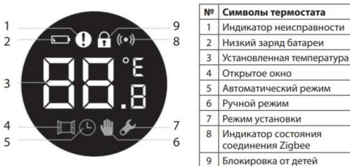
Рис. Устройство термостата
