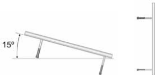
Монтаж теплообменников микроканальных типа MCHE
