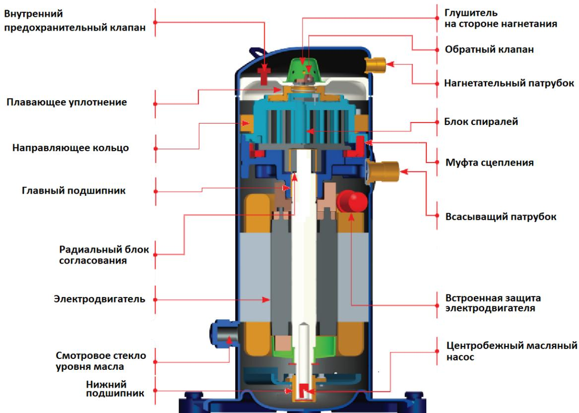
В компрессоре сжатие газа производится двумя элементами, имеющими форму спиралей, которые расположены в верхней части компрессора над электродвигателем (см. рисунок вверху). Всасываемый газ поступает в компрессор через всасывающий патрубок, обтекает электродвигатель, обеспечивая полное охлаждение компрессора во всех режимах работы. Капли масла, находящиеся в газе, выделяются из него и падают в картер компрессора. Пройдя через электродвигатель, газ попадает в спиральные элементы компрессора.
