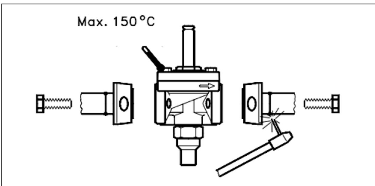
Внутренние поверхности и сварные присоединения клапана имеют антикоррозионную защиту. Для поддержания эффективности антикоррозионного покрытия, важно чтобы клапан разбирался
