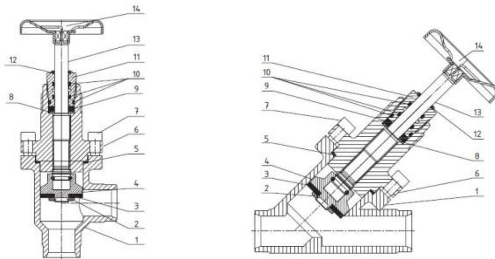
Рис. 1 – Конструкция клапана SVA
