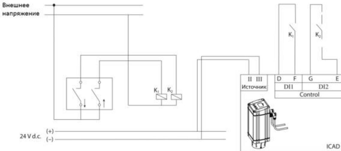
Рис. 7 Регулирование с нейтральной зоной (ступенчатое регулирование)
