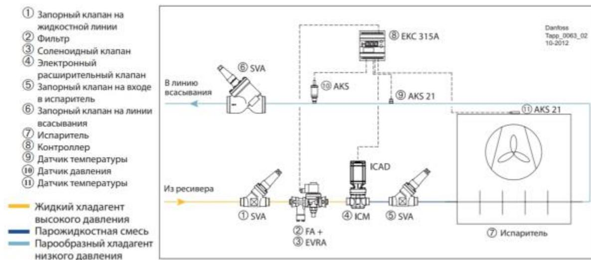
Регулирование подачи хладагента осуществляется электроприводным клапаном ICM (поз.4) с управлением от контроллера испарителя ЕКС 315А (поз.8). По данным, получаемым от датчика давления АКС (поз.10) и датчика температуры АКС 21 (поз.9), контроллер ЕКС 315А регистрирует перегрев пара на выходе из испарителя и регулирует степень открытия клапана ICM для поддержания перегрева на оптимальном уровне.
