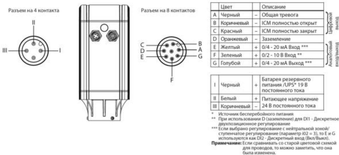
Рис. 4 Разъемы для подключения кабеля
