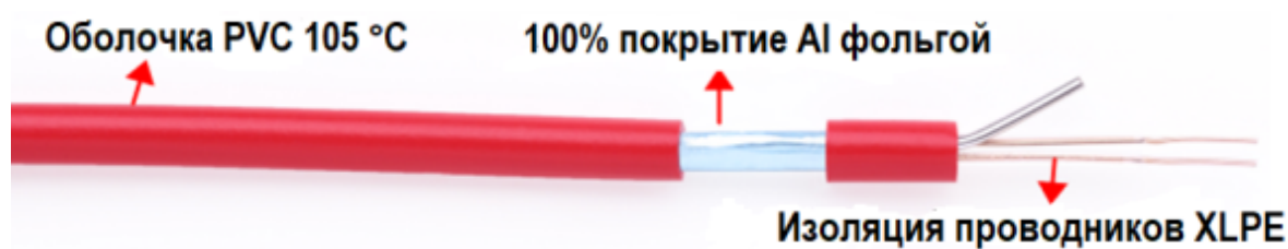
Рис. 2.1. Внешний вид разделанного кабеля ДЕВИ Flex-18Т и использованные материалы.
