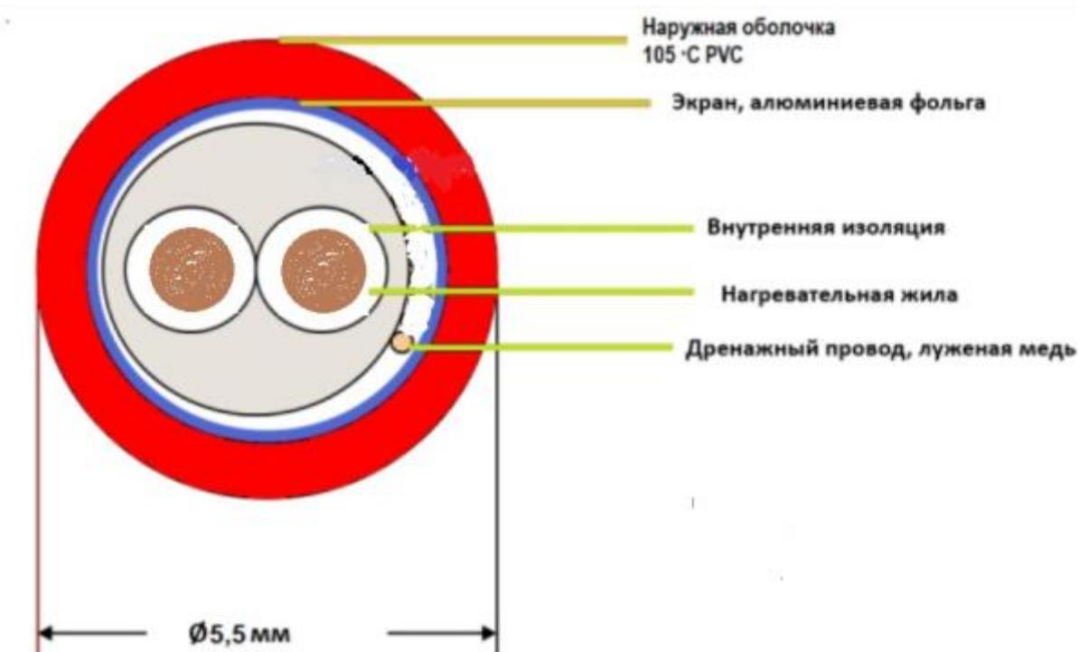
Рис. 2.2. Устройство нагревательного кабеля ДЕВИ Flex-18Т. Поперечный разрез.
