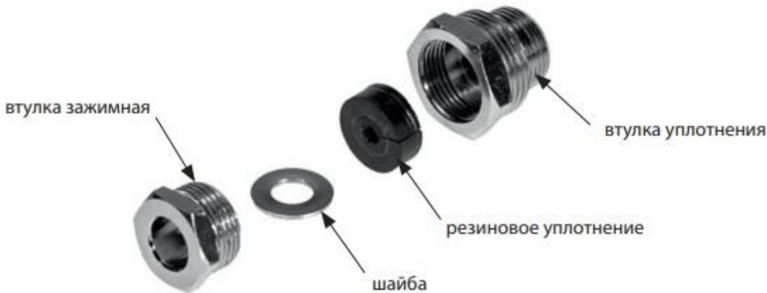
Все металлические элементы выполнены из латуни с хромированным покрытием и имеют повышенную стойкость к коррозии. Резиновое уплотнение имеет входное отверстие для установки нагревательного кабеля Ridan Pipeheat-15.
