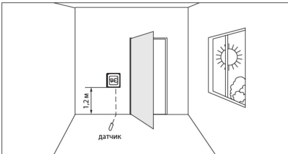
Подведите в гофротрубках питающие провода, соединительные кабели нагревательной секции, датчик температуры пола к монтажной коробке. Присоедините провода к клеммам терморегулятора согласно схеме электрических подключений (присутствует на корпусе терморегулятора):
