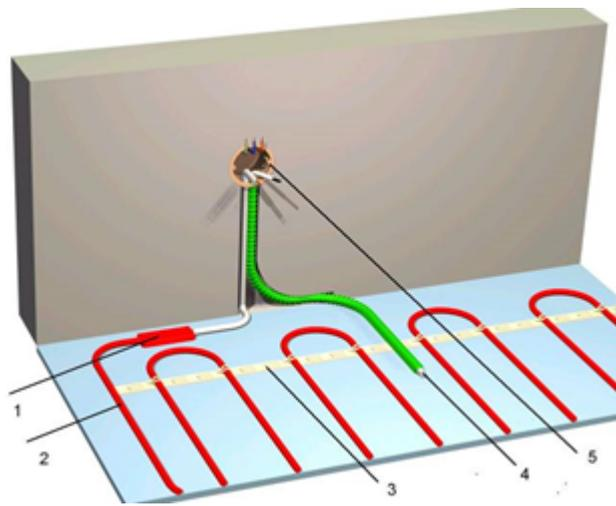
Монтаж датчика температуры в системе “Теплый пол” с нагревательным кабелем
