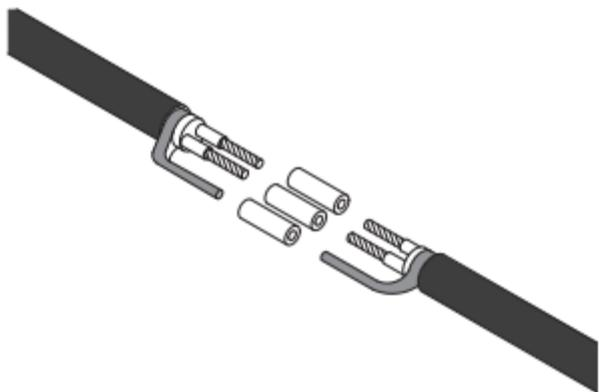
Герметизация устанавливаемой муфты обеспечивается термическим обжатием места электрического соединения термоусадочными трубками с клеевым слоем. Высокая надёжность муфты в условиях установки её во влажной среде достигается применением мастичной ленты RM 1103.
