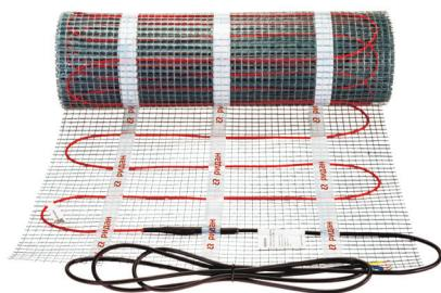
Нагревательный мат представляет собой тонкий нагревательный кабель, закрепленный на клейкой полимерной сетке с равномерным шагом укладки. Такая конструкция мата позволяет быстро и удобно монтировать его в тонкие несущие слои: плиточный клей, самовыравнивающийся раствор, штукатурная смесь и т. д.
