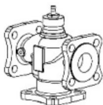
VF-3R – клапан регулирующий, трехходовой, седельный, фланцевый предназначены для применения без адаптера с электроприводами ARV(E)–1000R (DN 15–50), ARV(E)–1000R SU/SD (DN 15–50), AMV(E)-1800R, AMV–2000R SU/SD (DN 15–80), AME–2000R SU/SD (DN 40–80), в системах тепло- и холодоснабжения зданий, регулирования потока теплоносителя проходящего через него и получения необходимой температуры теплоносителя для потребителя.
