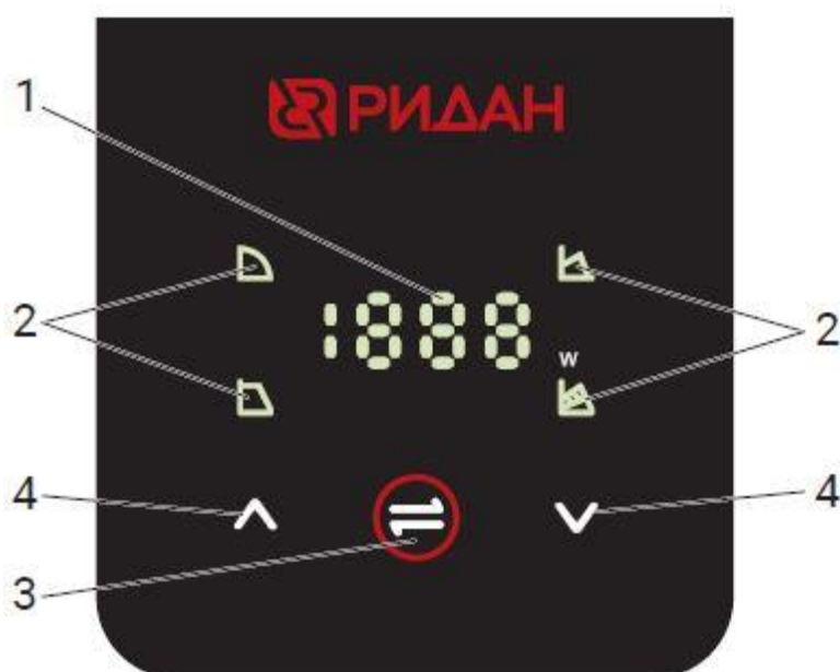
Рис. 5. Панель управления насосом RWE 40...80-XXX.
